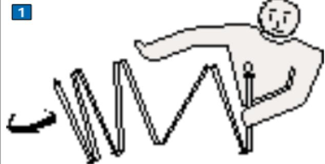
**ACHTUNG! DIE SONDE DARF HÖCHSTENS MIT ZWEI GANZEN UMDREHUNGEN DER MUTTER GESPANNT WERDEN, DA SONST DAS STAHLKABEL AUS SEINER VERANKERUNG GERISSEN WERDEN KANN!**
